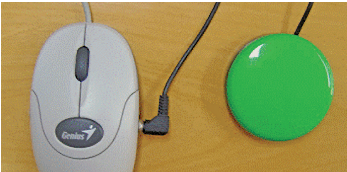
Foto 14 - Mostra um mouse com o acionador de pressão conectado.
